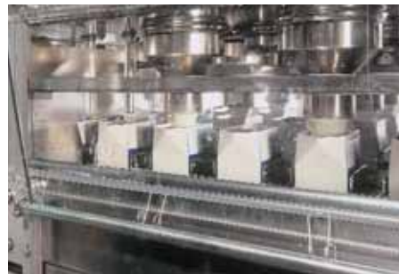
Überdruck im Füllraum hält die Hygiene-Bedingungen bei der Lebensmittel- und Pharma-Abfüllung aufrecht
