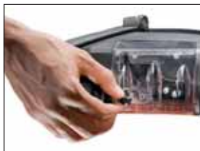
Scarico automatico della condensa per misure prolungate
