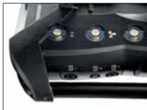
I filtri possono essere facilmente sostituiti senza attrezzi
