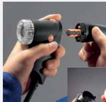
Sostituzione del puntale della sonda
