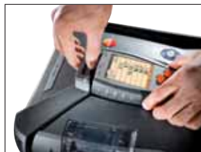
L'unità di controllo si inserisce con un semplice scatto
