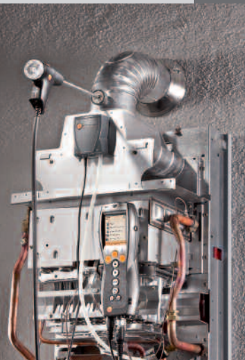
Die Feindrucksonde kann problemlos an jedem Messort befestigt werden – mit Bügel oder Magnet
