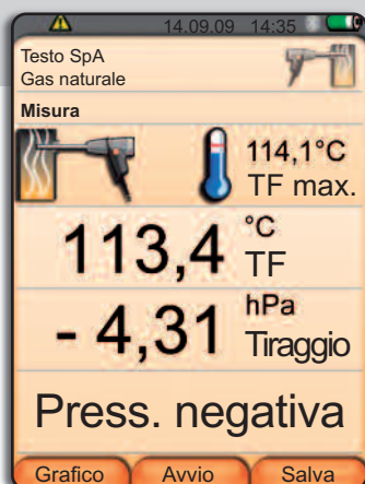
Il risultato della misura è una pressione negativa (-4,31 hPa)
