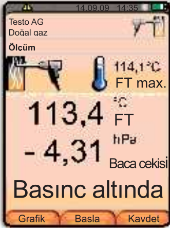
Ölçüm sonucu: negatif basınc var (-4.31 hPa)
