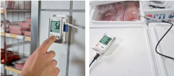
Abb. 7: Einsatz von Datenloggern
