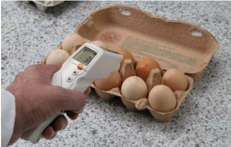
Abb. 5: Infrarot-Messung der Oberflächentemperatur an Nahrungsmitteln
