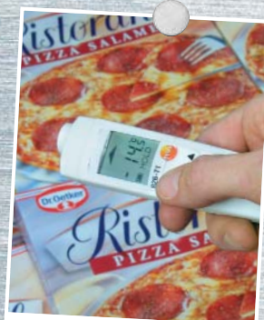
Felületi hőmérséklet mérése pl. az áru átvételekor
