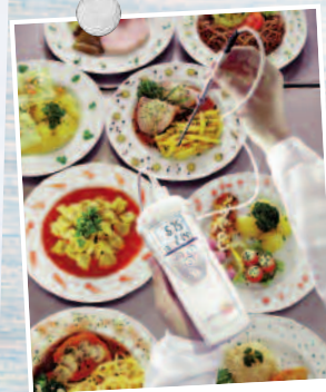
Проверка температуры блюд, напр., на линии раздачи питания
