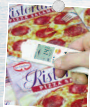
Измерение поверхностной температуры, напр., в процессе приемки продуктов
