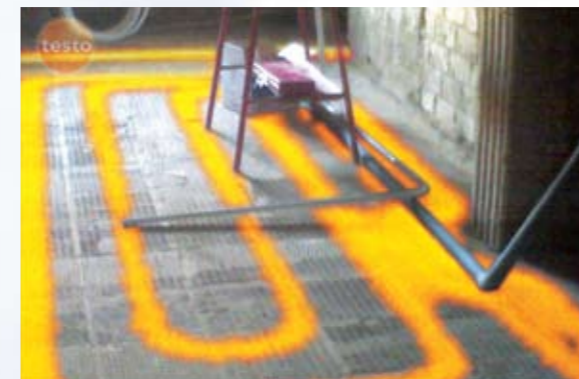
Podgląd instalacji ogrzewania podłogowego na zdjęciu rzeczywistym, dzięki funkcji TwinPix
