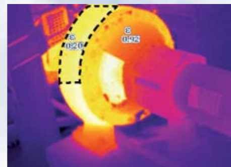
Zmiana emisyjności danego obszaru do precyzyjnej analizy rozkładu temperatur
