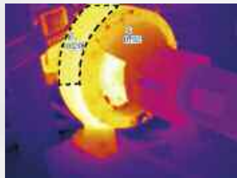
Modification de l'émissivité pour une analyse précise des températures
